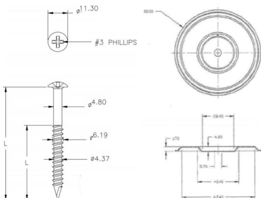
Fig. 1 – Système à induction OMG RHINO BOND
