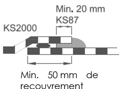
Fig. 5 – Raccord par recouvrement au moyen de la colle KS2000 et du mastic KS87
