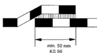
Fig. 4 – Raccord par recouvrement au moyen de colle KS96
