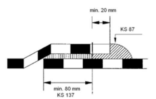
Fig. 3 – Raccord par recouvrement au moyen des colles KS137 + KS87
